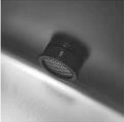
Um Verstopfungen durch Schmutzpartikel vorzubeugen, ist am Wassereinlass des Beckens ein abnehmbarer Filter angebracht.
