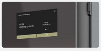
EEine Wartungshistorie registriert, wann das Gerät gespült, entkalkt oder der Wasserfilter ausgetauscht wurde.
